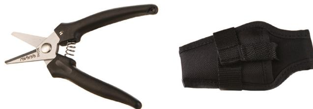
Cesoia da soccorso con lama in acciaio inox e con manico in plastica ABS. Lavorazione con molatura ad acqua, trattamento termico con durezza HRC 52-54. Sistema di fermo apertura di sicurezza. Astuccio in cordura con passanti per ancoraggio velcro.
