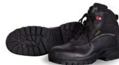
Calzatura alta di sicurezza con tomaia in pellame "Fiore" idrorepellente, inserti in cordura. Fodera con membrana impermeabile e traspirante in PTFE, imbottitura di protezione al malleolo allacciatura mediante lacci passanti ad anello METAL FREE. Puntale in Composito, soletta antiperforazione tessile, suola in gomma. Lavorazione AGO. Clip di sganciamento rapido.
