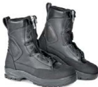
Calzatura di sicurezza Vigili del Fuoco in pelle fiore, tomaia in pelle pieno fiore nera, trattata idrorepellente e traspirante. Puntale di sicurezza realizzato in materiale composito. Foderata in tessuto tridimensionale molto traspirante. Sfilamento rapido con zip ad apertura totale. Suola con inserto antiperforazione composito. Tirante posteriore in pelle.
