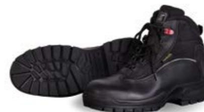
Chaussures de haute sécurité avec tige en cuir « Pleine Fleur » hydrofuge, empiècements en cordura. Doublure avec membrane en PTFE imperméable et respirante, rembourrage de protection de la malléole, fermeture à lacets, passants en boucle SANS MÉTAL, embout en composite, semelle intérieure en textile anti-perforation, semelle extérieure en caoutchouc. Exécution AGO. Clip de libération rapide.
